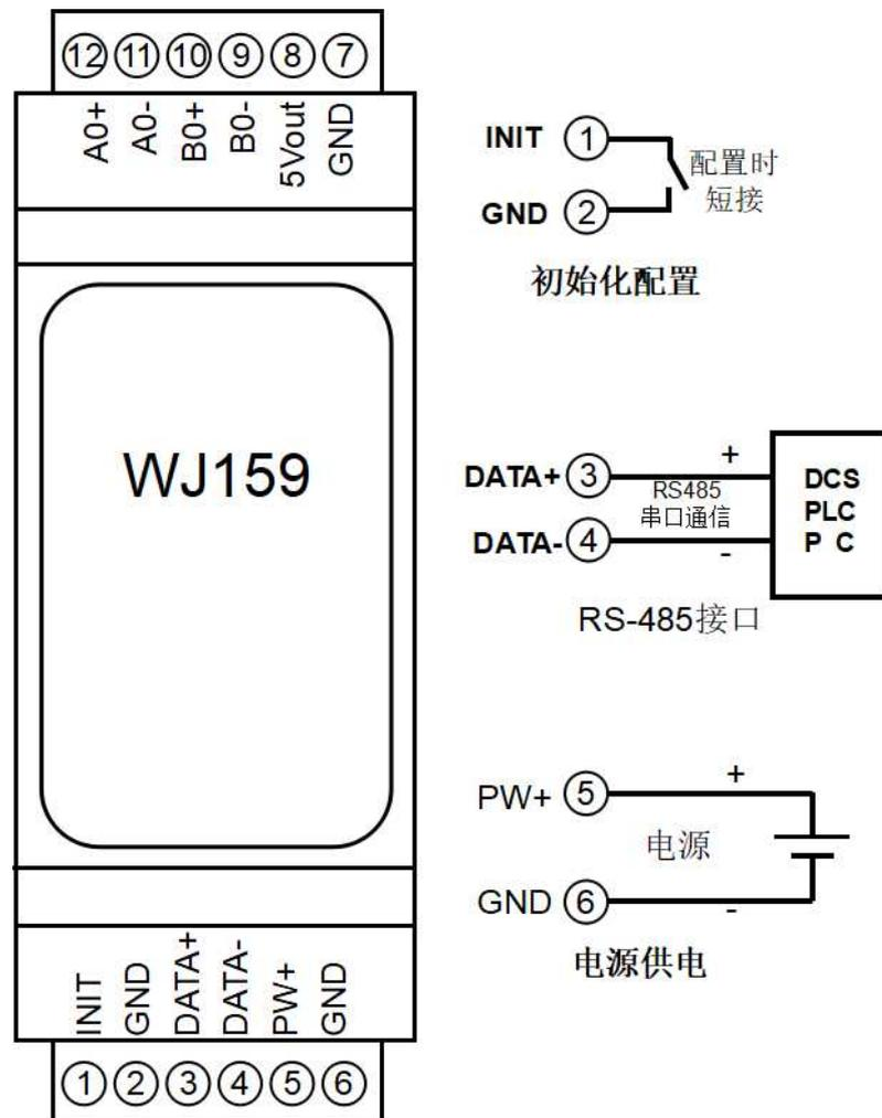
图3 WJ159 模块接线图
