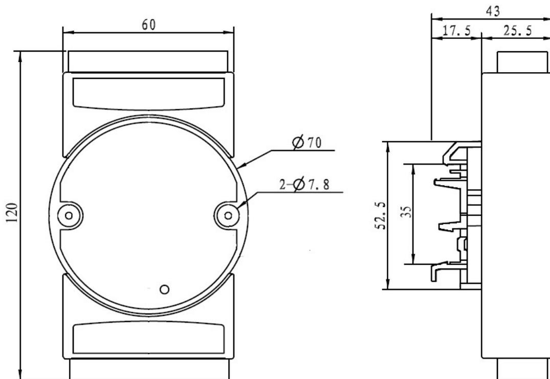
可以安装在标准 DIN35 导轨上
