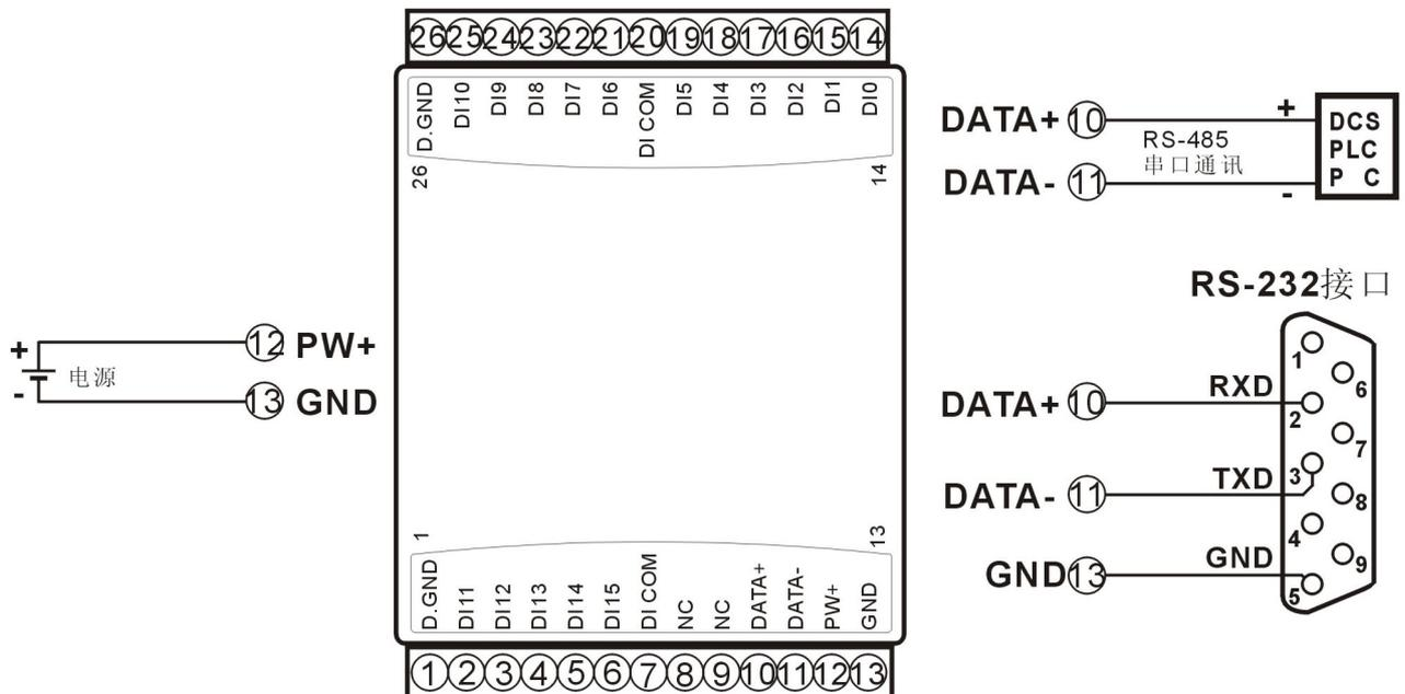
图3 WJ61 模块接线图
